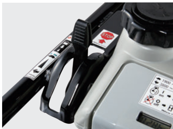
■ 燃料カットオフ機構連動キルスイッチ付スロットルレバー スロットルレバーに燃料コック及びストップスイッチを一体化し、運転・停止・アクセル動作をワンレバーで操作可能にしました。 (MTXシリーズ)
