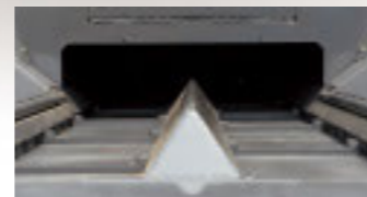
コンベヤ中央チェーンカバー
