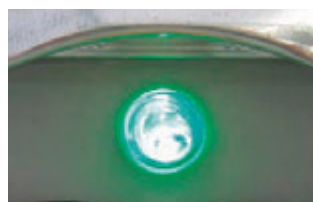
正常電圧時: 緑色点灯 警告電圧時: 緑色点滅
